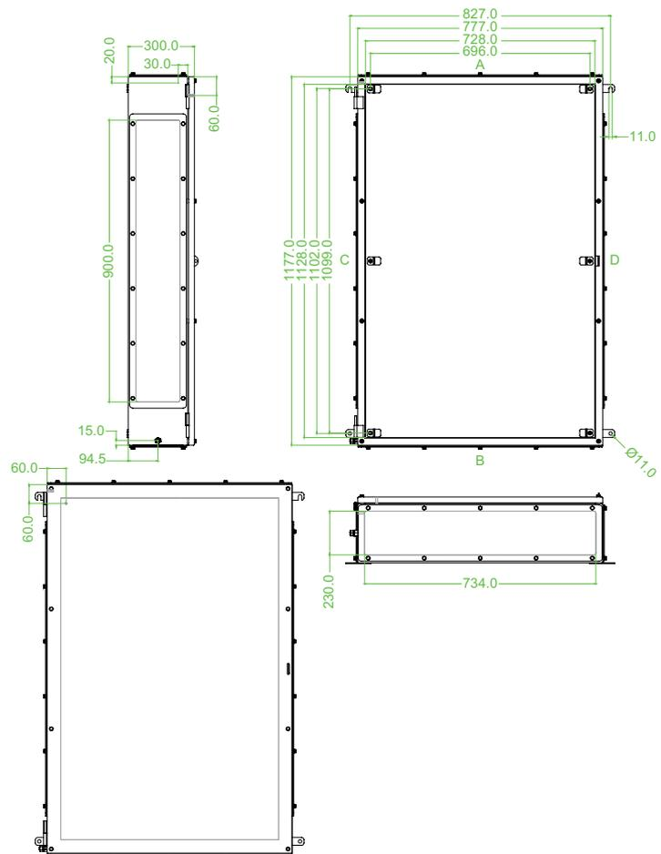
Abbildung/Maßzeichnung zeigt Version mit 4 Flanschplatten.
