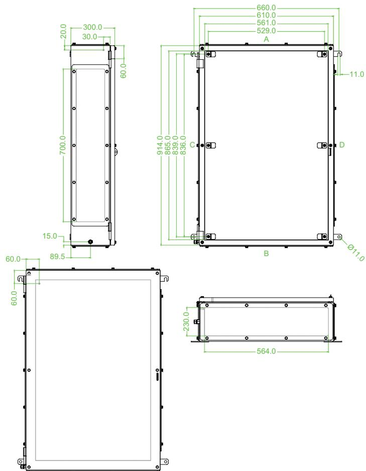
Abbildung/Maßzeichnung zeigt Version mit 4 Flanschplatten.
