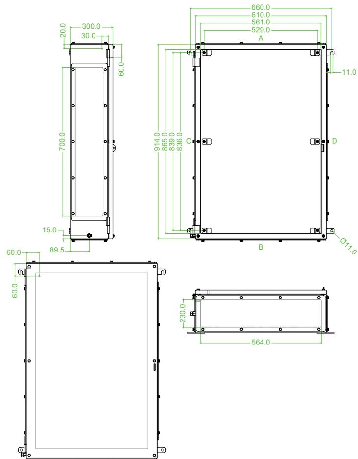
Abbildung/Maßzeichnung zeigt Version mit 4 Flanschplatten.
