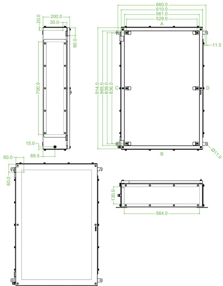
Abbildung/Maßzeichnung zeigt Version mit 4 Flanschplatten.
