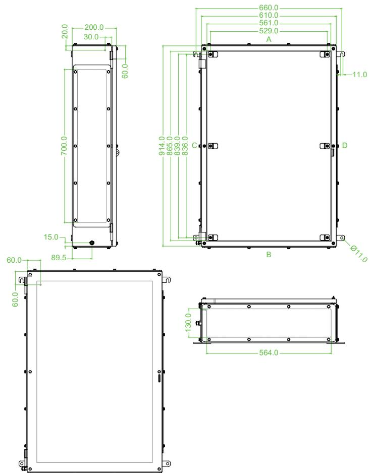
Abbildung/Maßzeichnung zeigt Version mit 4 Flanschplatten.
