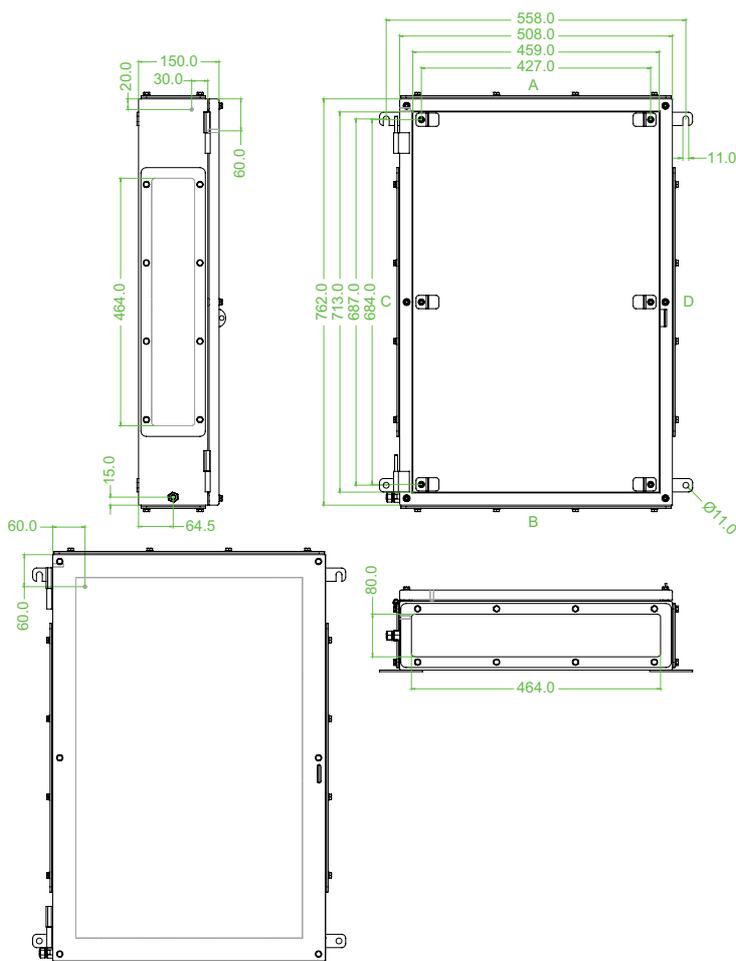
Abbildung/Maßzeichnung zeigt Version mit 4 Flanschplatten.
