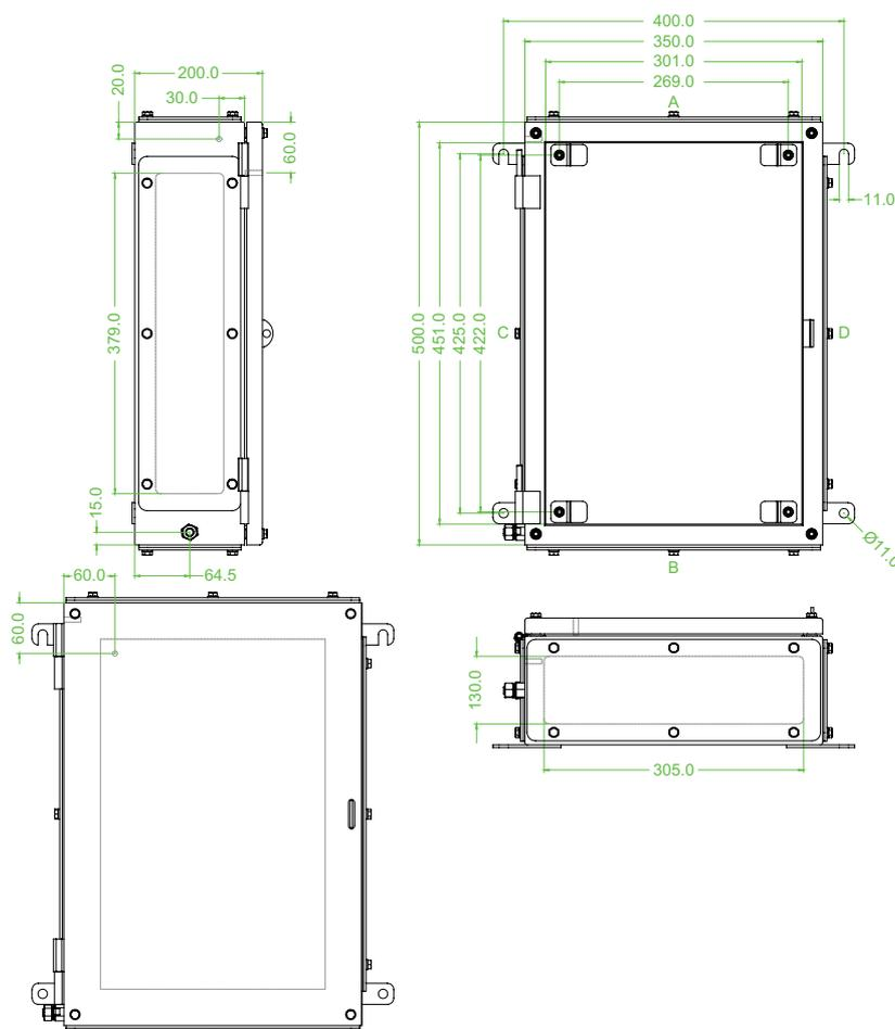
Abbildung/Maßzeichnung zeigt Version mit 4 Flanschplatten.
