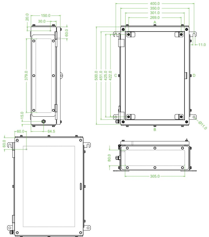
Abbildung/Maßzeichnung zeigt Version mit 4 Flanschplatten.
