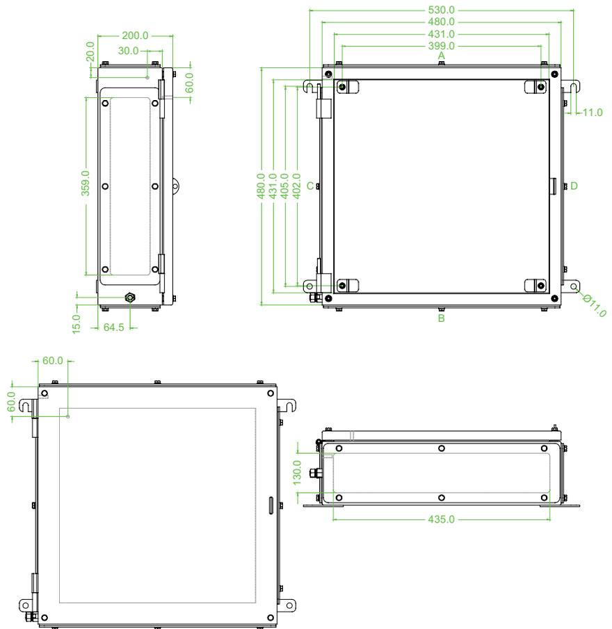
Abbildung/Maßzeichnung zeigt Version mit 4 Flanschplatten.
