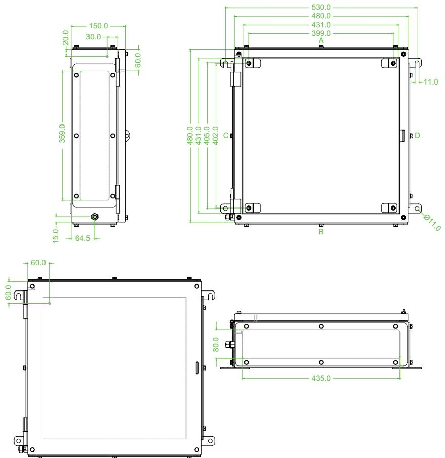
Abbildung/Maßzeichnung zeigt Version mit 4 Flanschplatten.
