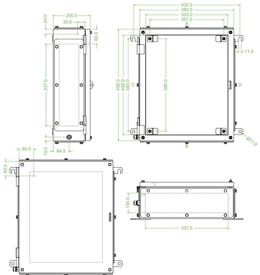
Abbildung/Maßzeichnung zeigt Version mit 4 Flanschplatten.
