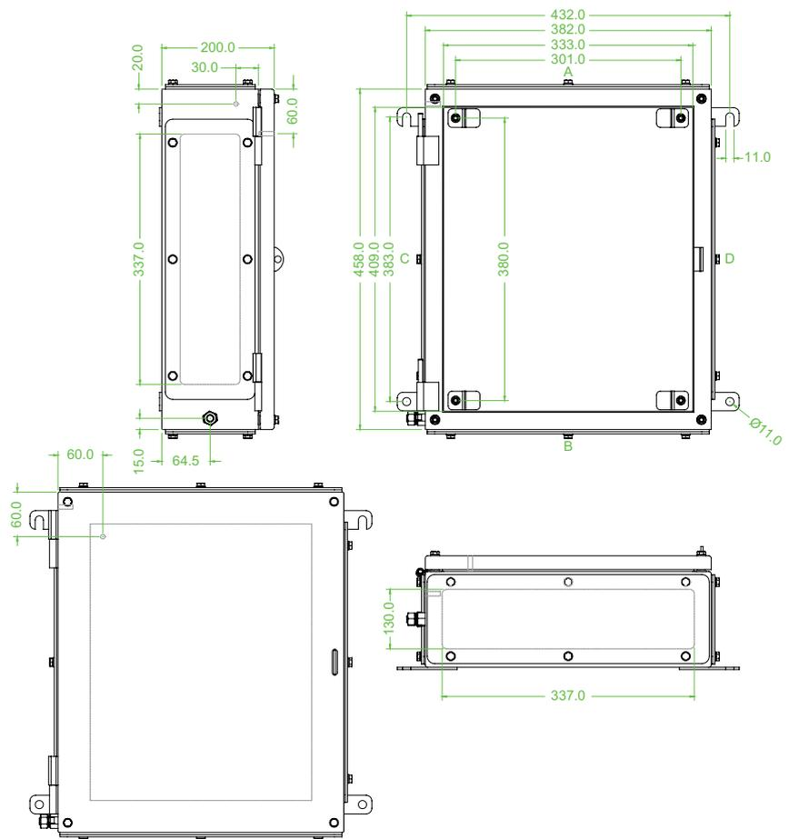
Abbildung/Maßzeichnung zeigt Version mit 4 Flanschplatten.
