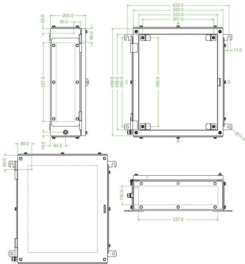
Abbildung/Maßzeichnung zeigt Version mit 4 Flanschplatten.
