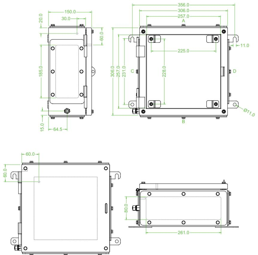
Abbildung/Maßzeichnung zeigt Version mit 4 Flanschplatten.
