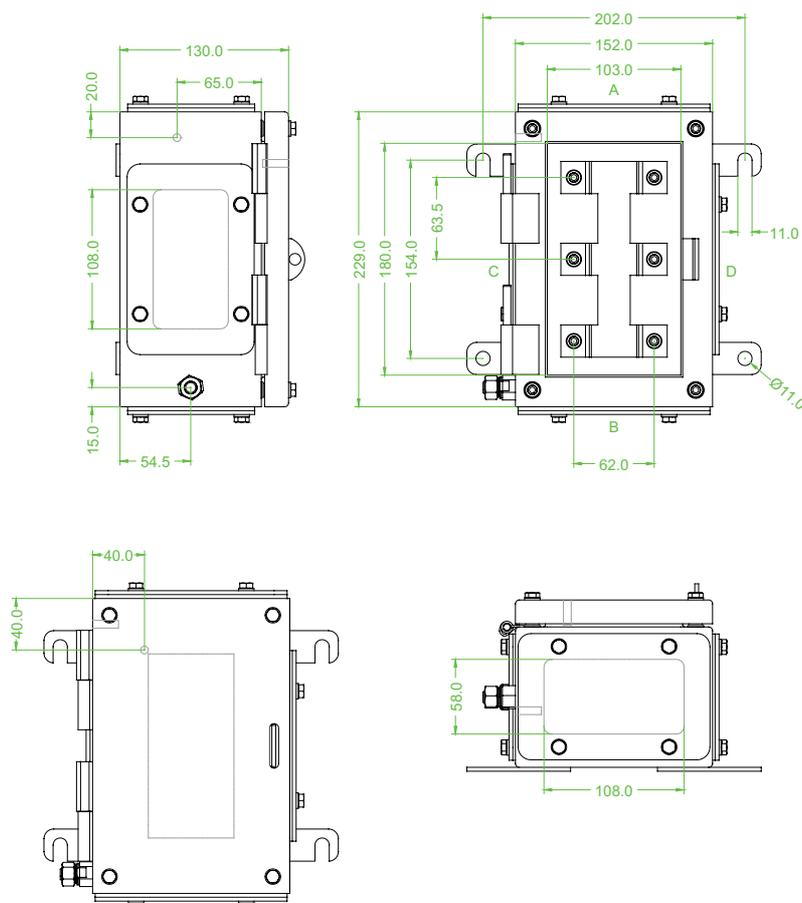
Abbildung/Maßzeichnung zeigt Version mit 4 Flanschplatten.
