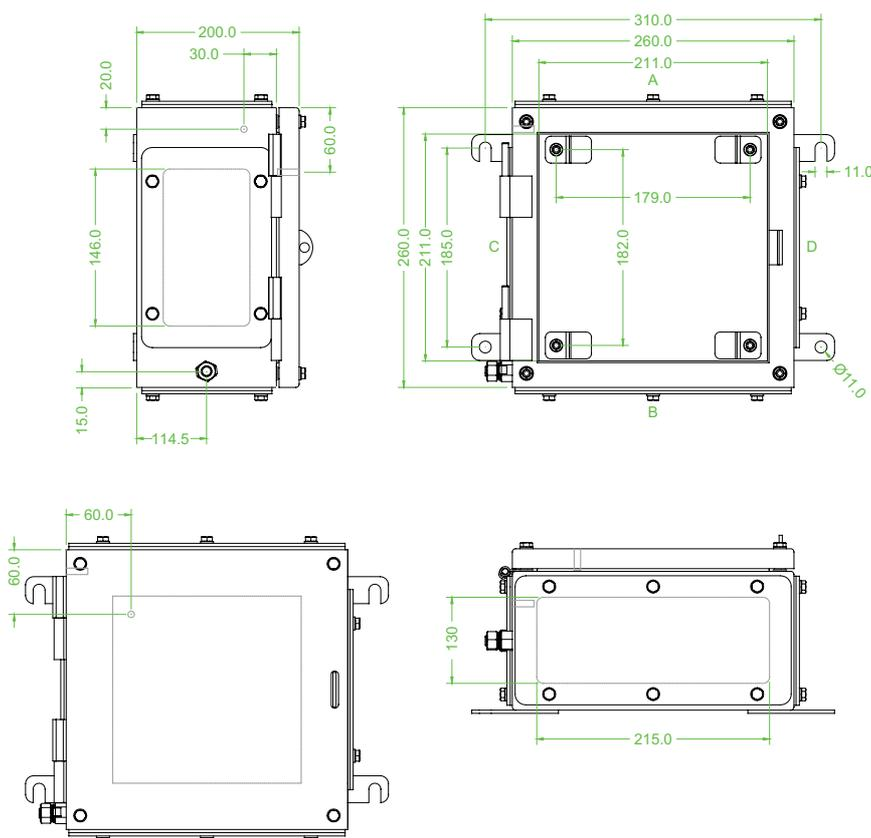
Abbildung/Maßzeichnung zeigt Version mit 4 Flanschplatten.
