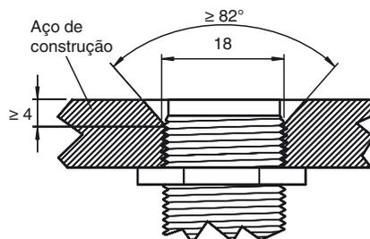
Superfície do sensor embutida no nível de montagem.
