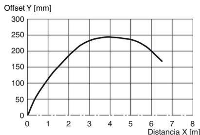
Desplazamiento posible de los ejes ópticos del emisor y receptor.
