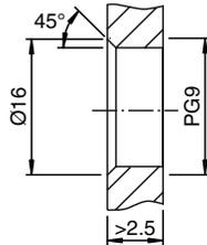
Coupe du boîtier pour filetage de fixation PG9, panneau de montage avec trou traversant (ou bien avec face anti-rotation) :
