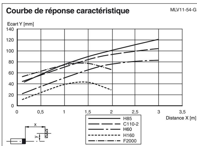
**Diamètre de la tache lumineuse = f (distance) MLV11-54-G**
