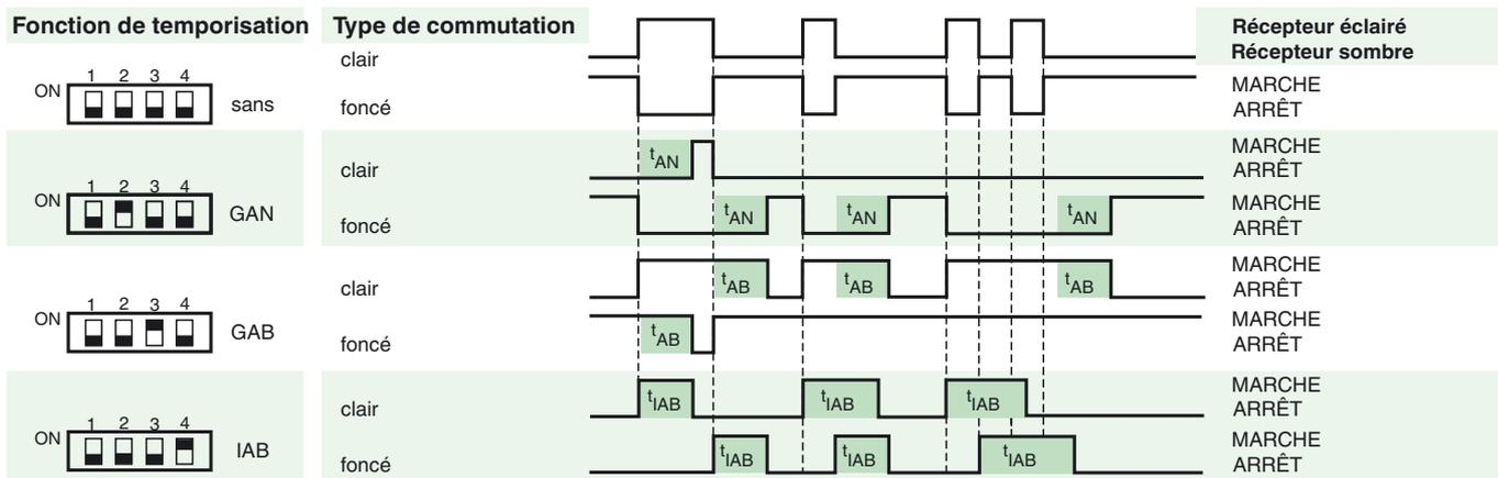
Les temps  $t_{AN}$ ,  $t_{AB}$  et  $t_{IAB}$  sont réglables de 0,02 à 1 seconde.
