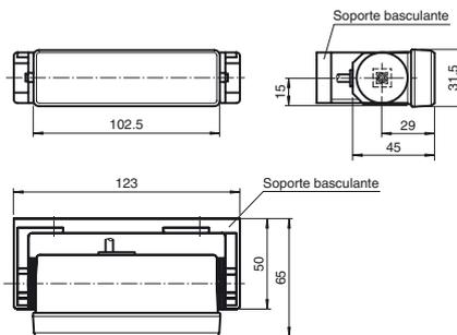
Dimensiones de montaje para soporte basculante
