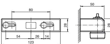
Misure di montaggio con il set della squadra di fissaggio AIR30
