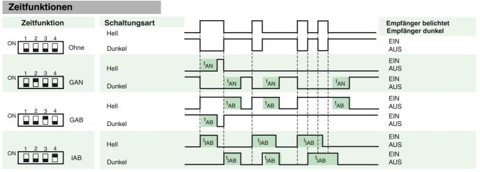
Die Zeit  $t_{AN}$ ,  $t_{AB}$  und  $t_{IAB}$  sind von 0,1 - 10 Sekunden einstellbar. Der H/D-Schalter (Schalter links außen) ist in Stellung Dunkelschaltung dargestellt.
