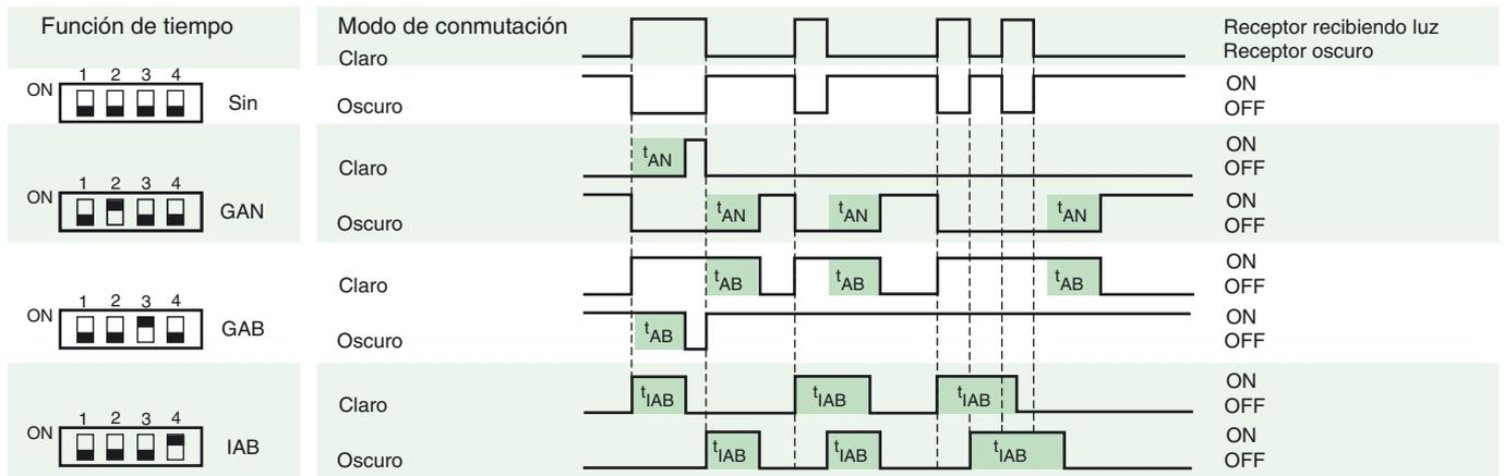
El tiempo  $t_{AN}$ ,  $t_{AB}$  y  $t_{IAB}$  es ajustable entre 0,1 y 10 segundos.
