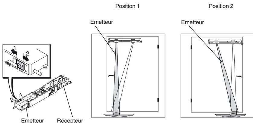
Le transmetteur de chaque capteur présente deux réglages de position de faisceau, grâce auxquels l'arête de surveillance peut être alignée sur la gauche ou sur la droite.
