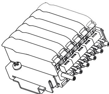
Vous pouvez connecter les boîtiers de raccordement esclaves au boîtier de raccordement maître à l'aide des contacts à pont fournis sur les boîtiers de raccordement esclaves.
