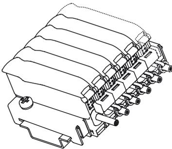
Le unità di controllo slave si collegano alle unità master tramite contatti a ponticello forniti sui moduli slave.
