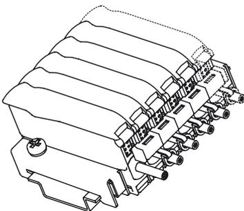
Mit den mitgelieferten Brückenkontakten an den Slave-Modulen können Sie die Slave-Module mit dem Master-Modul verbinden.
