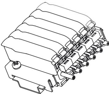
Los módulos esclavo pueden conectarse al módulo maestro usando los contactos de puente que se incluyen en los propios módulos esclavo.
