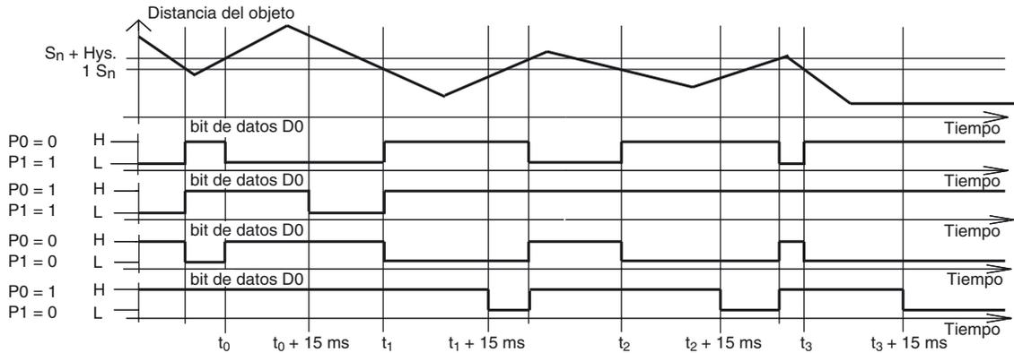
El retardo de conexión / desconexión está preajustado en modo conectado (P0=1). Retardo de conexión de 15 ms, cuando P0=1 y función de dispositivo de cierre (P1=1). Retardo de desconexión de 15 ms, cuando P0=1 y función de dispositivo de apertura (P1=0).
