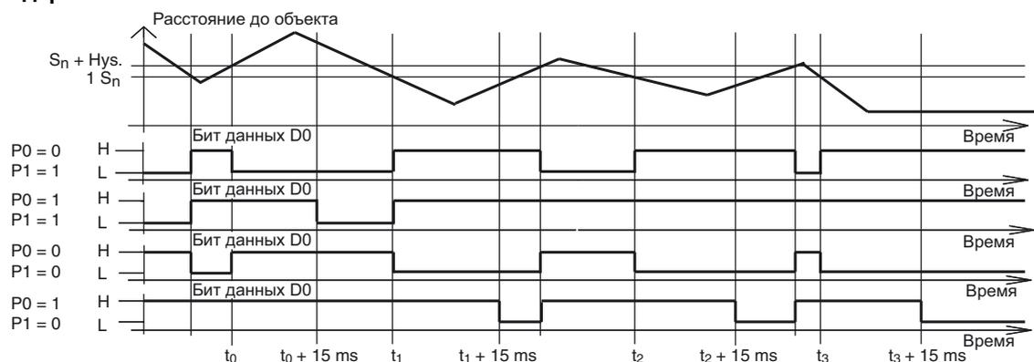
Задержка включения/выключения по стандарту установлена на включено (P0=1). Задержка включения на 15 мс, если P0=1 и функция замыкателя (P1=1). Задержка выключения на 15 мс, если P0=1 и функция размыкателя (P1=0).
