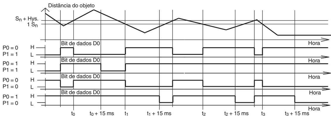
o atraso de conexão/desconexão está predefinido (P0=1). Atraso de conexão de 15 ms, se P0=1 e função de fechamento (P1=1). Atraso de desconexão de 15 ms, de P0=1 e função de abertura (P1=0).
