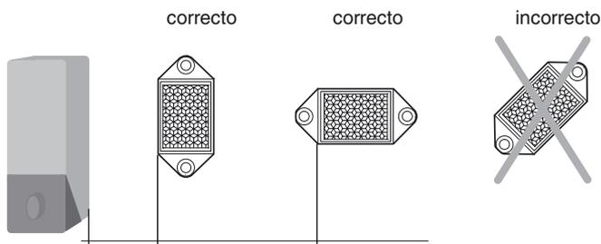
El borde del sensor y el borde del reflector deben estar paralelos.
