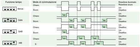
i tempi t<sub>AN</sub>, t<sub>AB</sub> e t<sub>IAB</sub> sono regolabili tra 0,1 s e 10 s L'interruttore chiaro/scuro (interruttore sul lato esterno sinistro) è rappresentato in posizione di azionamento in scuro
