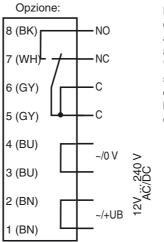
Le funzioni del relè "contatto di riposo" e "contatto normale aperto" si riferiscono alla configurazione circuitale "blanking", nella cui posizione si devono trovano i due commutatori unblanking/ blanking (= condizione in fase di consegna).
