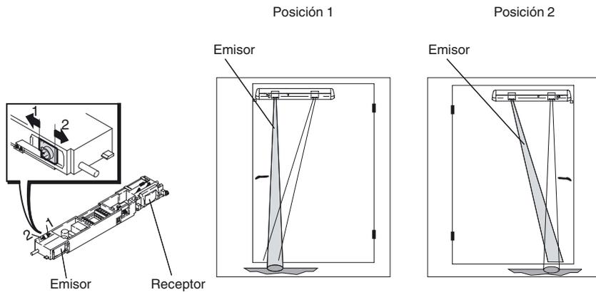
El transmisor de cada sensor incluye dos posiciones de ajuste del haz que permiten alinear el punto de supervisión a la izquierda o a la derecha.
