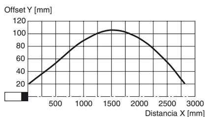
Desplazamiento posible entre el eje óptico y el retroreflector.
