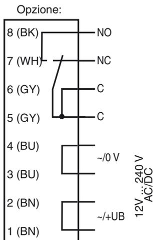
Le funzioni del relè "contatto di riposo" e "contatto normale aperto" si riferiscono alla configurazione circuitale "unblinking", nella cui posizione si trova il commutatore unblinking/blinking nella parte superiore del contenitore (= condizione in fase di consegna).
