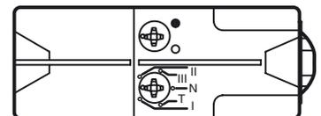
Es posible conmutar directamente de los grados de reconocimiento de contraste, sin tener que colocar el conmutador giratorio de nuevo en la posición T. Para la función de reconocimiento de contraste (teach-mode) la reserva de función debe alcanzar al menos 2,5 (véase la curva «potencia relativa de recepción lumínica»).
