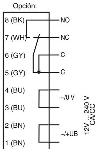
Las funciones de relé «abrir» y «cerrar» se refieren al modo de conmutación «conmutación clara», en cuya configuración se encuentra el conmutador claro/oscuro en la parte superior de la carcasa (= estado en la entrega).
