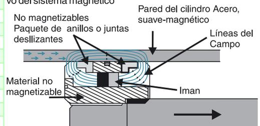
Con este sistema de sensores no sirve montar simplemente un iman permanente en el pistón. Debe construirse un sistema magnético que introduzca con precisión el flujo magnético de los imanes permanentes en la pared del cilindro, para alcanzar así una imantación muy elevada. Los detalles para la construcción de un sistema magnético están descritos en el manual. Antes de cualquier aplicación en serie se recomienda un ensayo general práctico!
