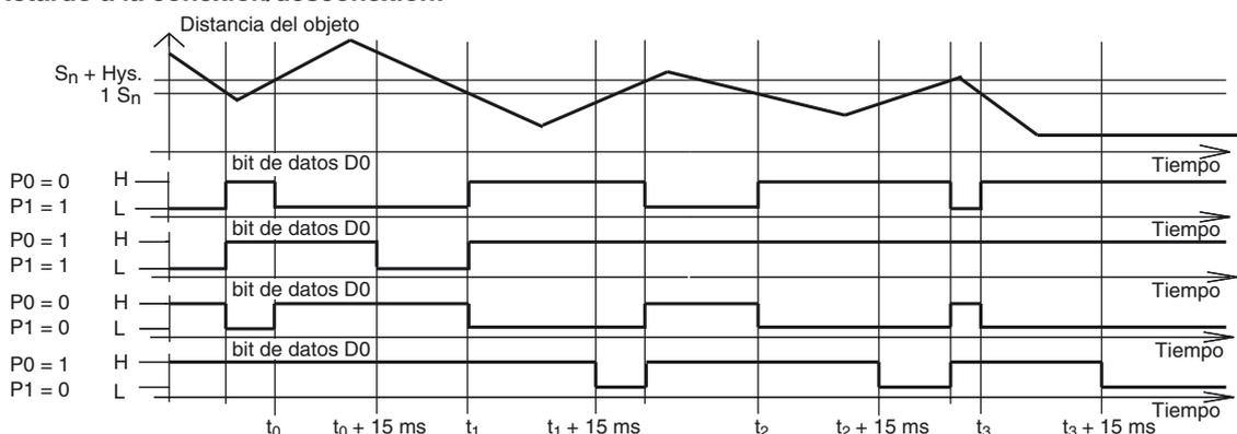
Preajustado del retardo a la conexión/desconexión (P0=1). Retardo a la conexión en 15 ms, con P0=1 y función N.A. (P1=1). Retardo a la desconexión en 15 ms, con P0=1 y función N.C. (P1=0).
