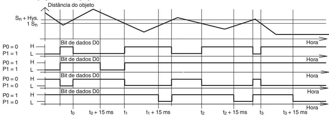
O atraso de ligação / desligamento predefinido está acionado (P0=1). Atraso de ligação em 15 ms, se P0=1 e função de fechamento (P1=1). Atraso de desligamento em 15 ms, se P0=1 e função de abertura (P1=0).
