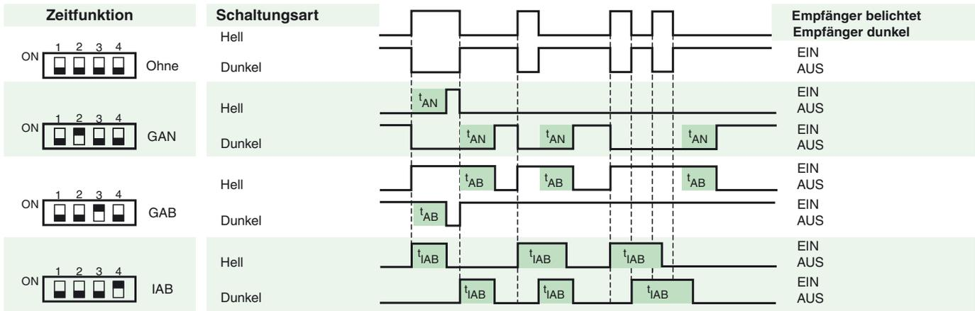
Die Zeit  $t_{AN}$ ,  $t_{AB}$  und  $t_{IAB}$  sind von 0,02 - 1 Sekunden einstellbar.
