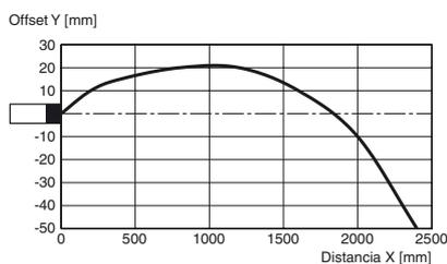
Desplazamiento posible entre el eje óptico y el objeto.
