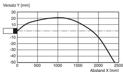
Möglicher Abstand (Versatz) zwischen optischer Achse und Objekt.
