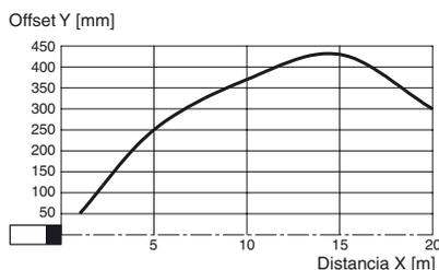
Desplazamiento posible entre el eje óptico y el retroreflector.
