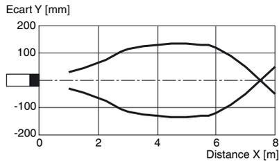
Ecart possible entre l'axe optique et le rétroreflécteur.
