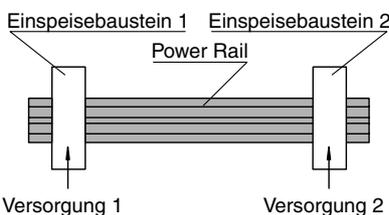
Durch die Reversdiode „R“ können **zwei** Einspeisebausteine auf einem Power Rail zur redundanten Speisung verwendet werden.
