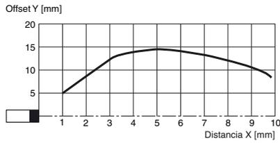
Desplazamiento posible entre el eje óptico y el retroreflector.
