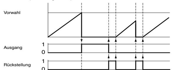
bedeutet "Wischimpuls-Ausgang" (50 ms ... 1s)
